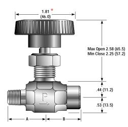
Panel Hole Diameter: 0.45 (11.4) Max Panel Thickness: 0.25 (6.4)
